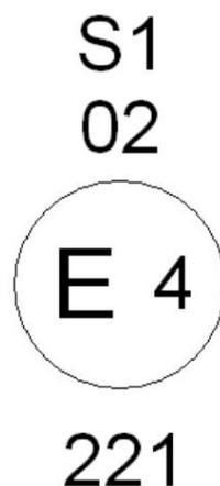
Le dispositif portant la marque d'homologation ci-dessus est un feu stop à un niveau d'éclairage homologué aux Pays-Bas (E 4) sous le numéro d'homologation 221 conformément au règlement n° 7 de l'ONU.
